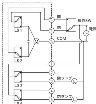
(注) C接点タイプは1つの切換スイッチで2台以上のモーター弁を動かさないで下さい。
